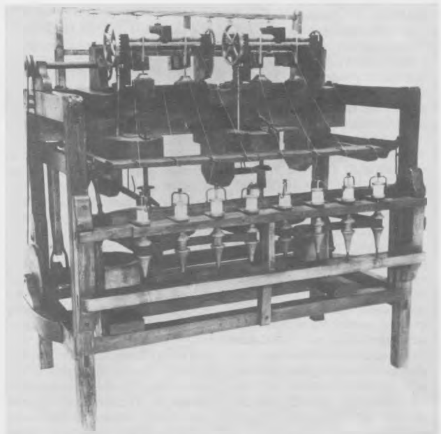
Water Spinnmaschine, erste Konstruktion von Arkwright, Cromford, Derbyshire, England (1769)
